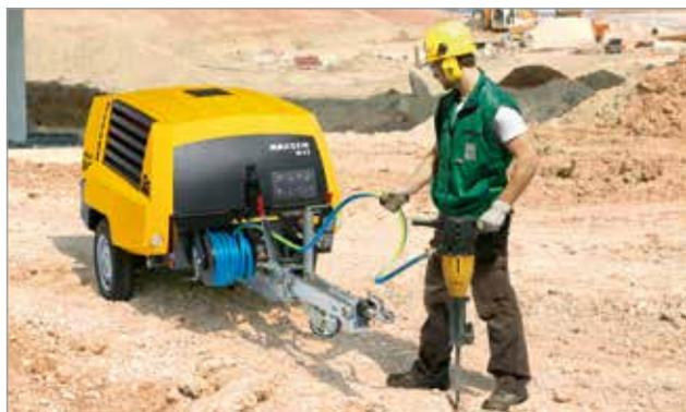
Les compresseurs de chantier MOBILAIR dans la plage de débit de 2 à 5,6 m<sup>3</sup>/min ne craignent pas le froid : la régulation antigel brevetée KAESER adapte automatiquement la température de service des machines à la température ambiante. En combinaison avec le graisseur de ligne disponible en option, elle protège les outils pneumatiques contre le gel et augmente leur disponibilité et leur longévité.
