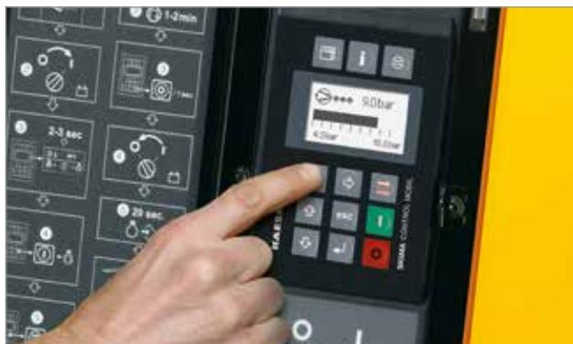
La commande de compresseurs innovante SIGMA CONTROL SMART ou SIGMA CONTROL MOBIL est facile à utiliser et permet d'importantes économies de carburant grâce à l'adéquation parfaite entre le moteur et le groupe moto-compresseur des MOBILAIR jusqu'à 34,0 m<sup>3</sup>/min.
