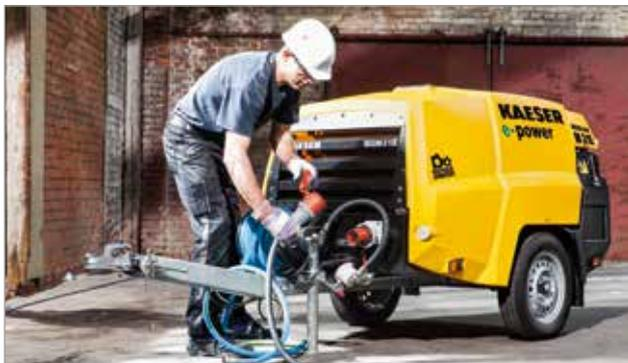
Les nouveaux compresseurs de chantier M27E, M31E et M50E révèlent tous leurs avantages sur les chantiers disposant d'un raccordement électrique. Le moteur électrique silencieux leur ouvre l'accès aux zones à faibles émissions de gaz et aux zones réglementées en terme de bruit. Les utilisateurs de ces compresseurs dans les bâtiments ou les tunnels ne sont plus exposés aux émissions de gaz et moins soumis à de fortes nuisances sonores.
