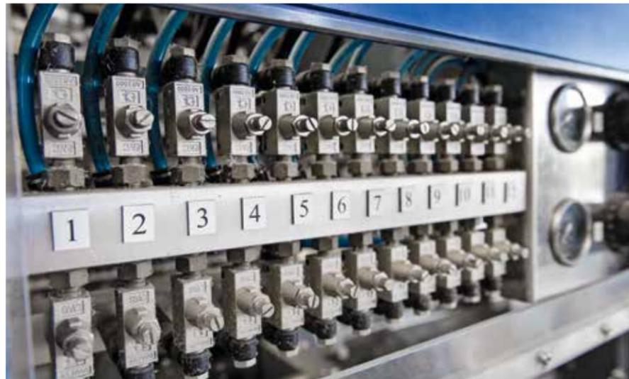
Commande de l'air stabilisant pour la tête de paraison
