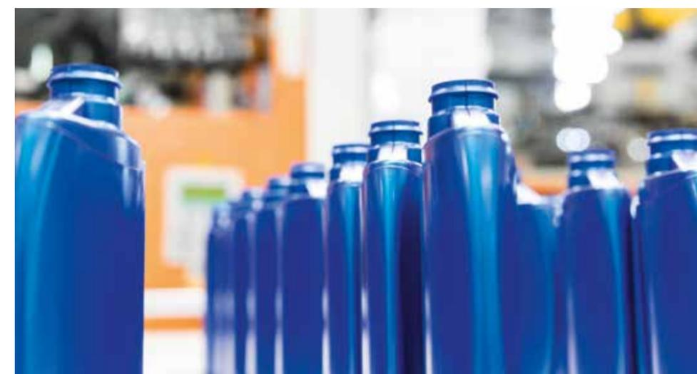
Les bouteilles finies à la sortie de la machine d'extrusion-soufflage
