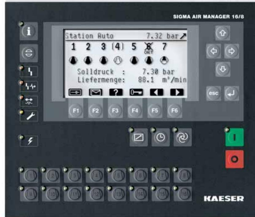
La commande interne de compresseur Sigma Control représente la base du système. Elle pilote et contrôle le compresseur à vis. L'échange de données entre Sigma Control et Sigma Air manager s'effectue par l'interface Profibus DP.
