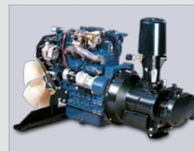
Le bloc vis Kaeser au profil Sigma, économique en énergie et travaillant à petite vitesse de rotation, constitue la base fondamentale de l'excellente „Performance“ des M 36 et M 45. Il est accouplé directement au moteur turbo diesel Kubota à quatre cylindres refroidi par eau. Cet entraînement direct 1:1 travaille sans perte de puissance par transmission. L'équipement en série d'un filtre carburant avec décanteur d'eau garantit une sécurité de fonctionnement accrue.
