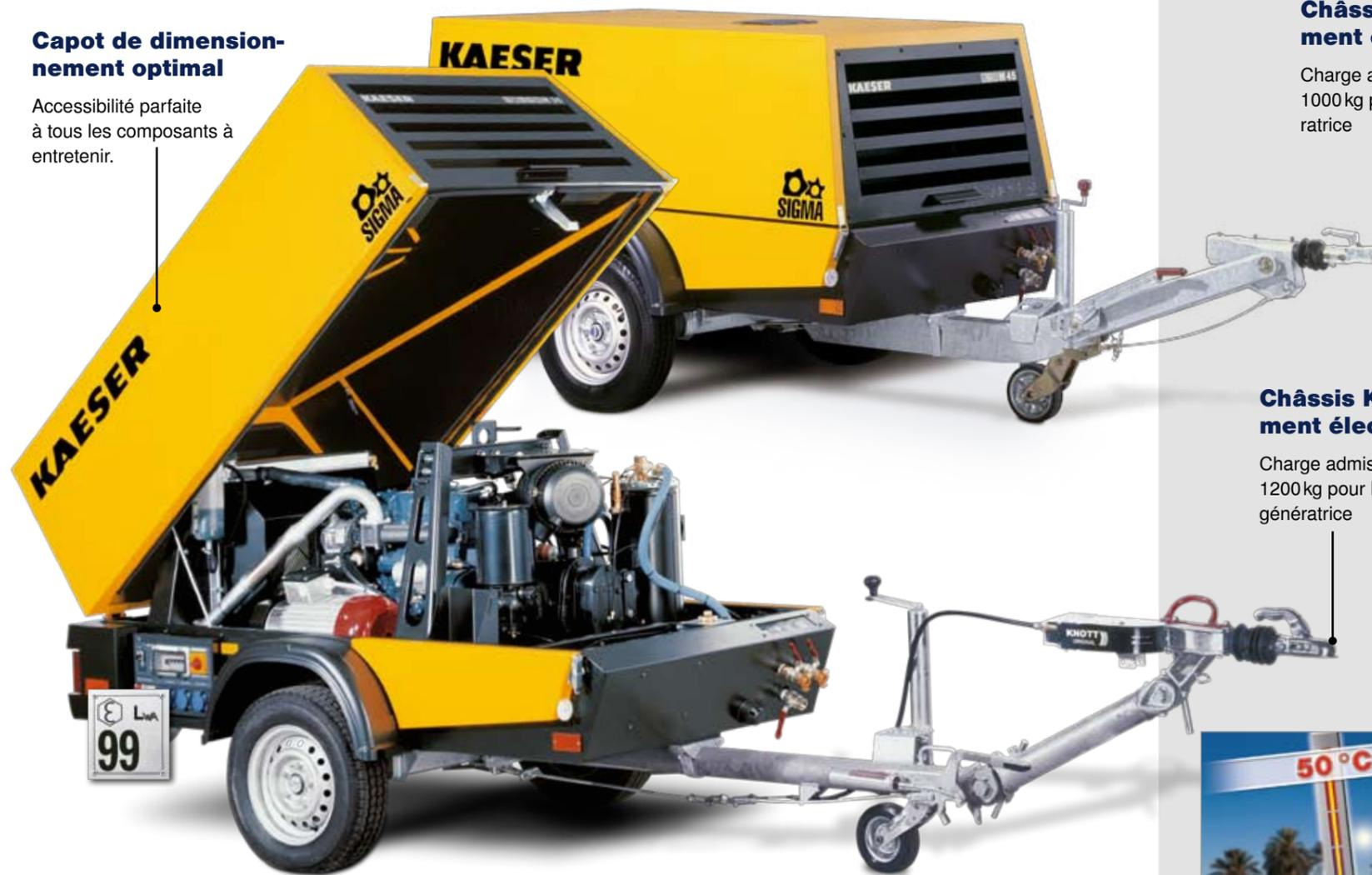
**Châssis ALKO entièrement électro-zingué**
