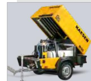
Le capot tout acier insonorisé offre une protection anticorrosion durable et préserve la valeur de la machine dans le temps grâce à la galvanisation et au revêtement par poudre. Tous les compresseurs stationnaires sont livrés avec un capot métallique.
