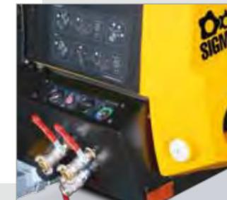
Le contacteur de démarrage doté d'une fonction de préchauffage et les pictogrammes explicites simplifient la commande de la machine. Le système de surveillance automatique arrête immédiatement le compresseur en cas de défaut. Un manomètre et l'indicateur de la température finale de compression informent l'utilisateur sur l'état de fonctionnement de la machine.
