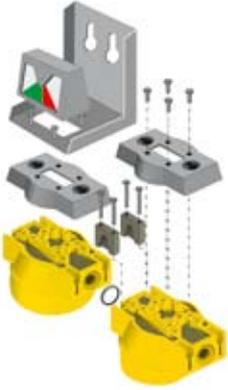
Concept modulaire permettant le raccordement aisé de filtres supplémentaires (par ex. pour former une chaîne de filtration FFG)
