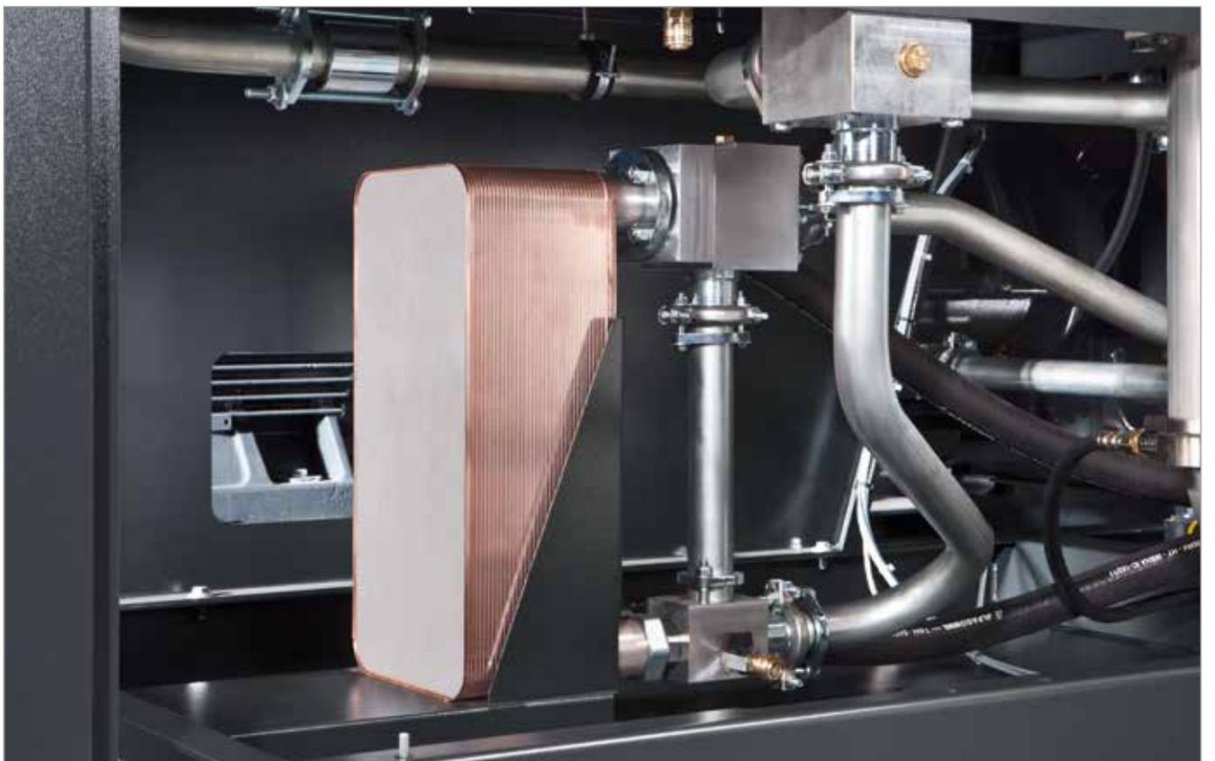
Fig. : Intérieur d'un compresseur – échangeur de chaleur à plaques, vanne thermostatique et tuyauterie
